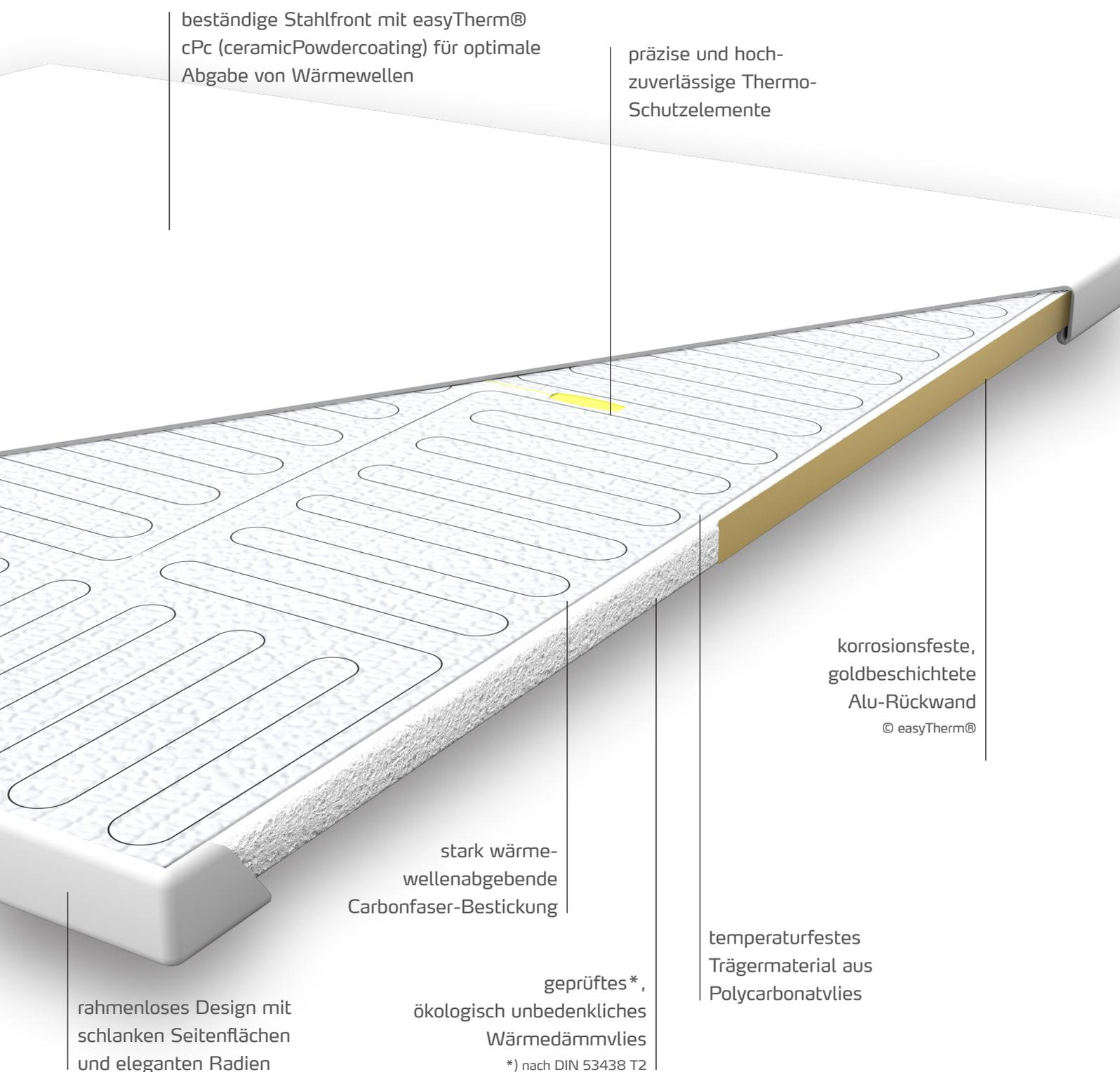
beständige Stahlfront mit easyTherm® cPc (ceramicPowdercoating) für optimale Abgabe von Wärmewellen
